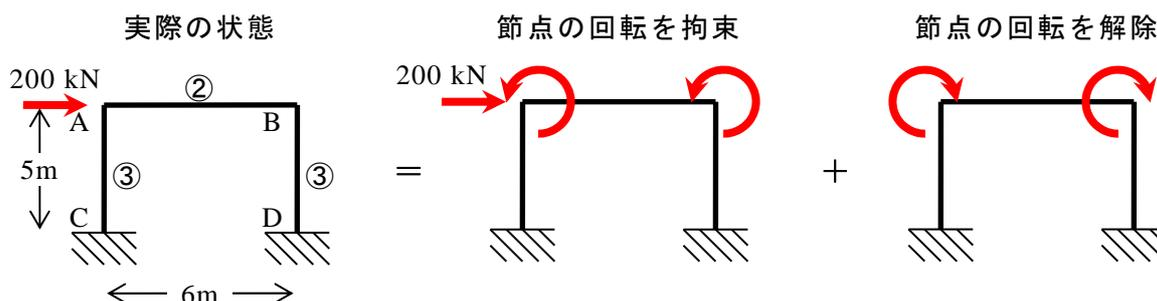
節点 A,B の回転を拘束した状態を考えると、図 3.5 と同じ状態である。梁 AB は逆対象部材なので、有効剛比は、 $2 \times 1.5 = 3$  となり、節点 A の分配率は、0.5 ずつである。柱頭・柱脚の固定端モーメント FEM を仮に -100 (反時計回り) とおいて、固定法で応力を求める。節点 A に拘束モーメント -100 を作用させた状態をまず考える。実際には、この -100 の拘束モーメントは存在しないので、解除モーメント 100 を作用させたモーメント図を求め、重ね合わせれば求めるモーメント図が得られる。
