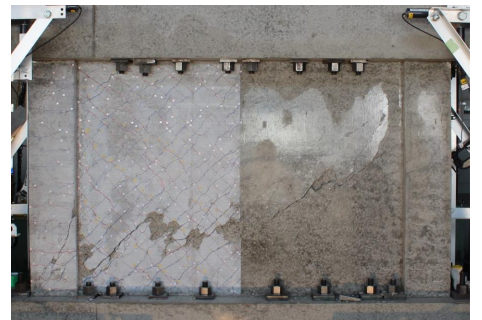
写真 最終破壊状況
