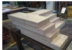
写真-3 作製した T 形部材
