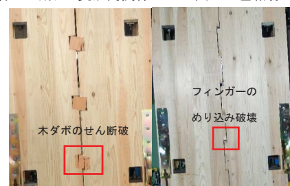
写真-2 接合部の最終破壊状況(左：2D-Dow-S,右：2D-Dov-C)
