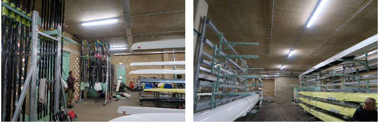
ボートハウス1階 細いRC柱で300mmの2階スラブを受ける。1階床はアスファルト敷、壁煉瓦積
