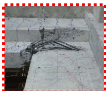
図3 2015年試験体の開口隅角部の配筋と損傷
